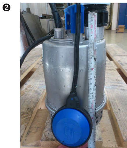
2 Vipan johdon tulee olla 150mm pitkä pumpusta uimurin alapuolelle.
